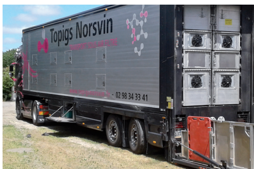
Livraison des cochettes par camion sous air filtré dans le but de conserver le sanitaire.
